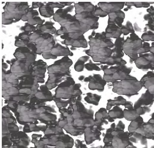
Bild 4: AFM-Aufnahme eines mit 8% Montmorillonit gefüllten dynamischen Vulkanisats auf Basis PP/EPDM 30/70 (links) und Einfluss des Nanofüllstoffanteils auf den dynamischen Modul E' (rechts).
