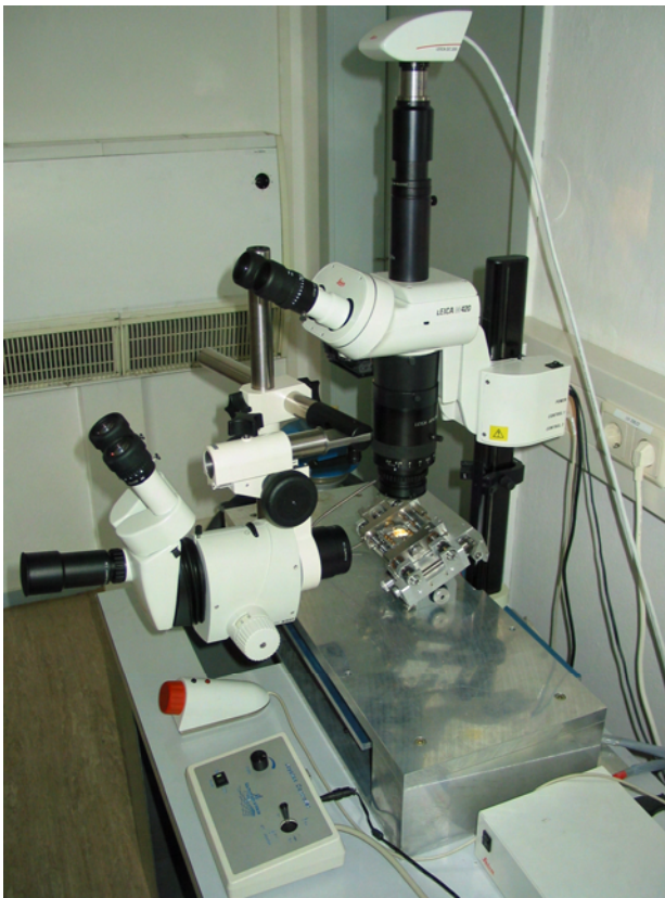
Abb. 1 Messplatz für Zugversuche an Miniaturprüfkörpern unter lichtmikroskopischer Kontrolle
